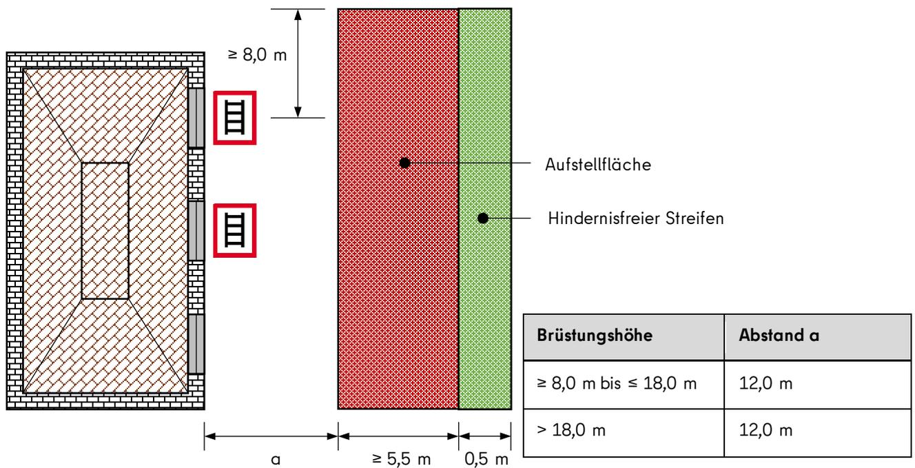
Abb. 9: Aufstellfläche parallel zur Außenwand, a = 12 m
