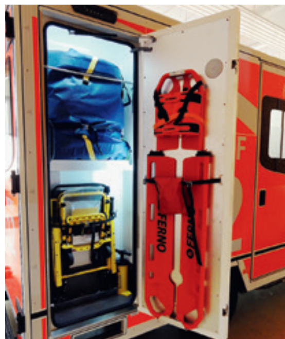
Die Aufteilung des Innenraums im neuen „RTW 2020“. Im Seitenfach sind außen Tragestuhl, Schaufeltrage und Vakuummatratze verstaut.
