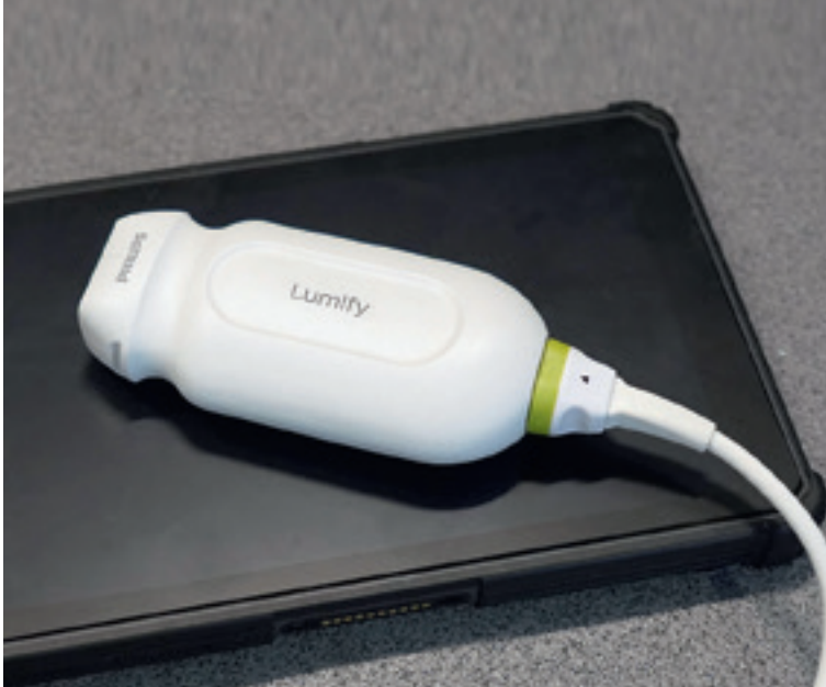
Tragbares Ultraschallgerät „Lumify“ zur Untersuchung bei internistischen und chirurgischen Notfällen.
