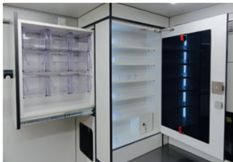
An der Stirnwand des Aufbaues ist ein großzügiger Schrank mit Stauraum installiert.
