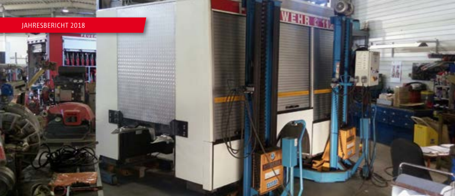
Instandgesetzter Aufbau kurz vor Wiedermontage Bild: Berliner Feuerwehr
