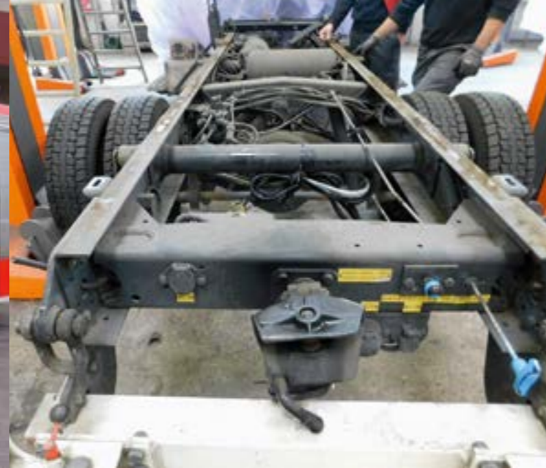
Instandsetzung eines defekten Fahrzeughauptrahmens Bild: MAN
