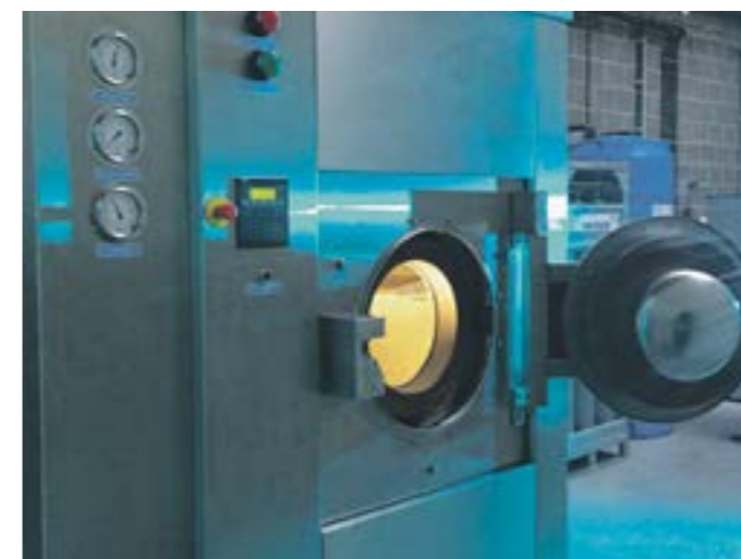
Waschmaschine mit einem Fassungsvermögen von 4 Anzügen, also ca. 60 kg Bild: Otmar Schneider
