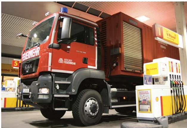
Fahrzeug mit Abrollbehälter-Generator
