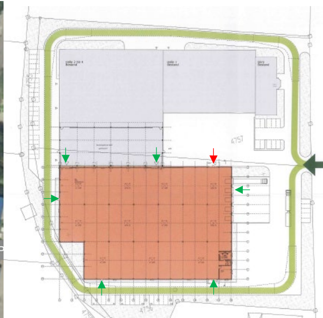
Abbildung 5: Der erste Angriffsweg ist mit einem roten Pfeil markiert. Diese Tür ist der Brandstelle am nächsten. Die weiteren optionalen Angriffswege sind die Rettungswege des Gebäudes (grüne Pfeile) bzw. die Tore der Laderampe. Berliner Feuerwehr, 2019.
