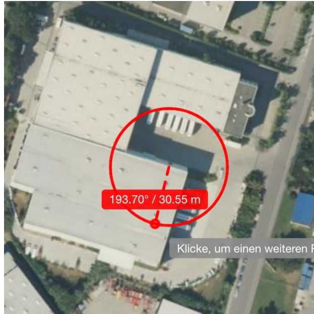
Abbildung 4: In der Kreismitte ist das erste Strahlrohr positioniert. Der Radius beschreibt den möglichen Arbeitsbereich des Druckluftschäumstrahles. Berliner Feuerwehr, 2019.
