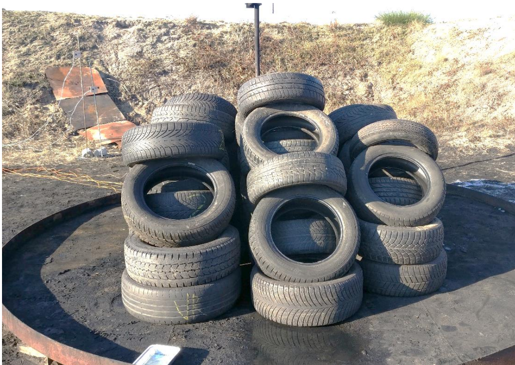
Abbildung 2: Anordnung der Reifen vor der Zündung. Bild: Berliner Feuerwehr, 2016.
