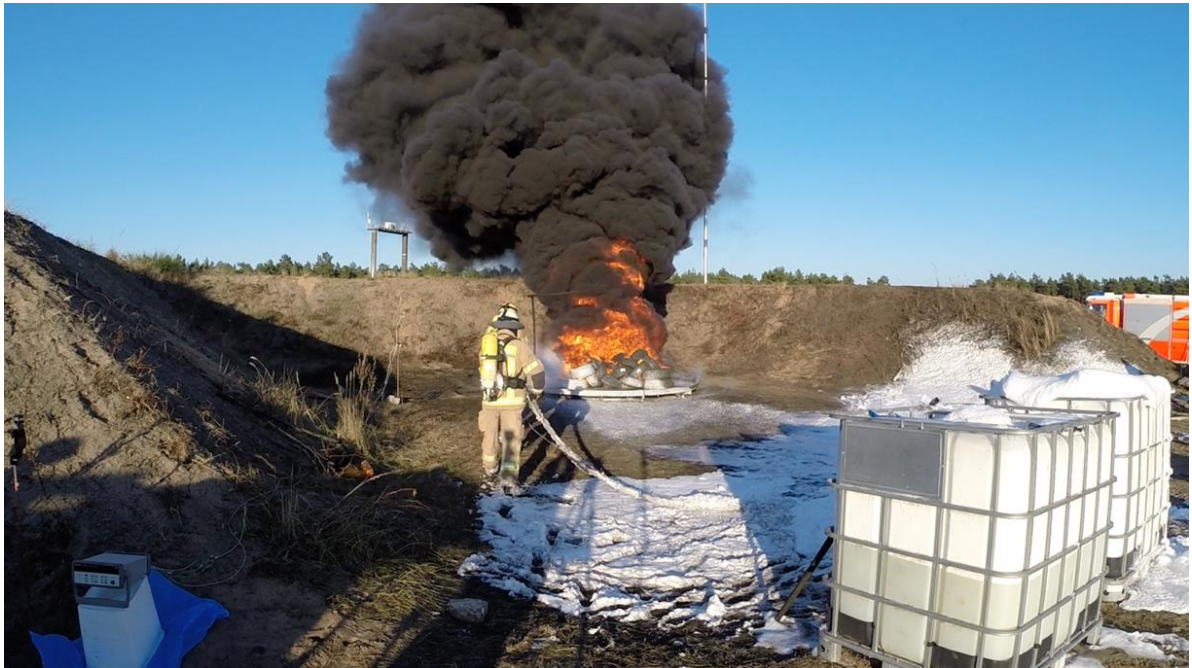
Abbildung 7: Versuch 9. Der Angriffstrupp der Berliner Feuerwehr startet die Brandbekämpfung mit Druckluftschäum aus sicherer Entfernung. Bild, Berliner Feuerwehr, 2016.
