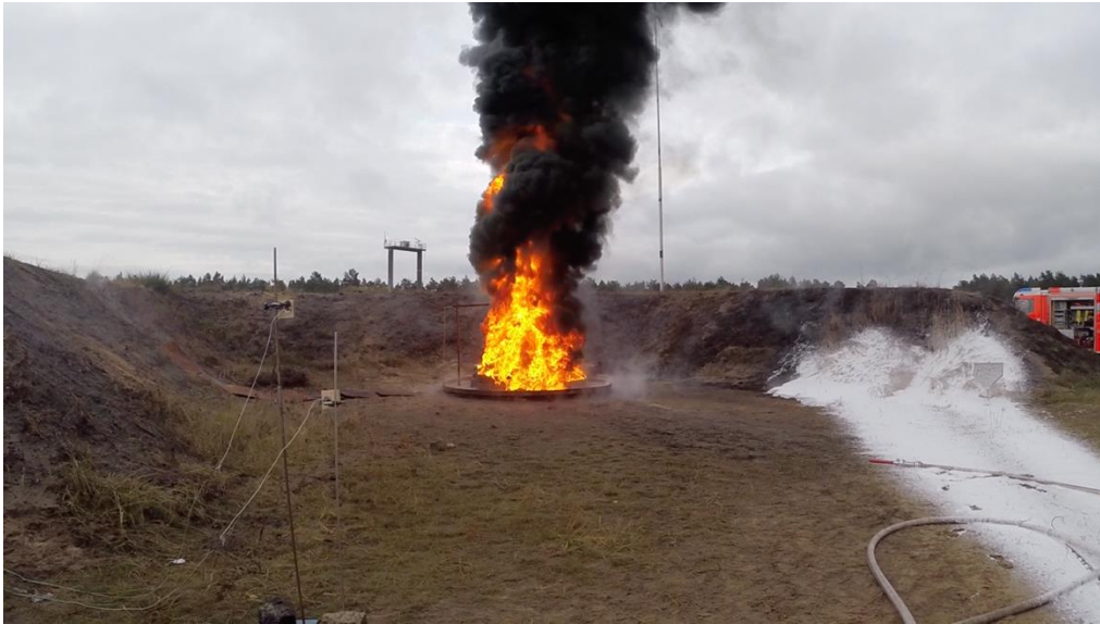
Abbildung 4: Brennender Reifenstapel des Vorversuches. Die Brandstelle ist an 3 Seiten mit einem Sandwall umgeben. In Abbildung 1 als Brandwall bezeichnet. Bild: Berliner Feuerwehr, 2016.
