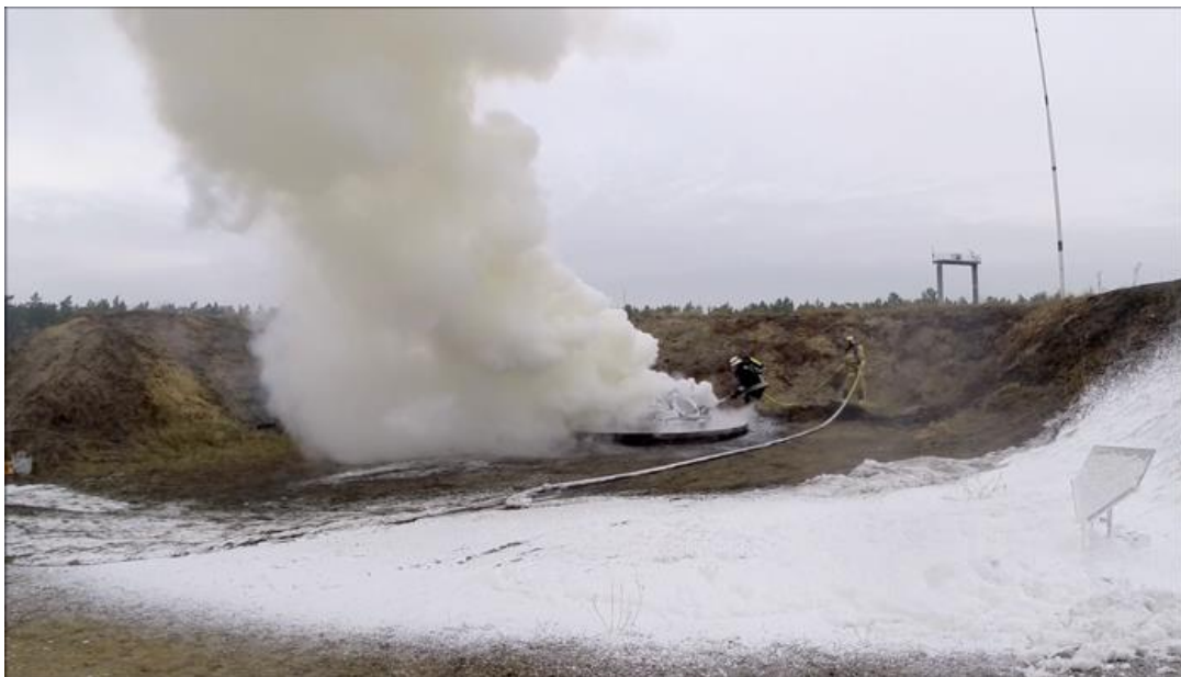
Abbildung 6: Zeigt die Lage 30 Sekunden später. Die Wärmefreisetzung konnte deutlich reduziert werden. Das Feuer flammte noch einige male kurz auf. Nach insgesamt 57 Sekunden endete die primäre Brandbekämpfung. Bild: Berliner Feuerwehr, 2016.
